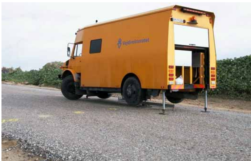
Figur 1. Vejteknisk Instituts pladebelastningsbus under måling.
