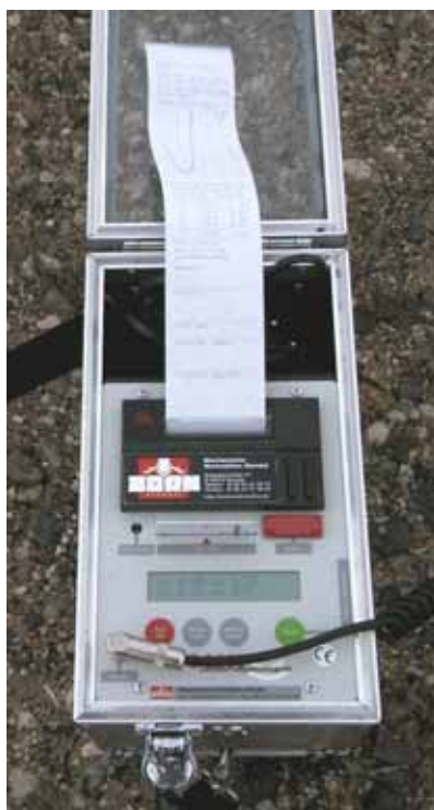
Figur 10. Zorn-minifaldlod. Nærbillede af dataopsamlingsenhed med strimmel med måleresultater.
