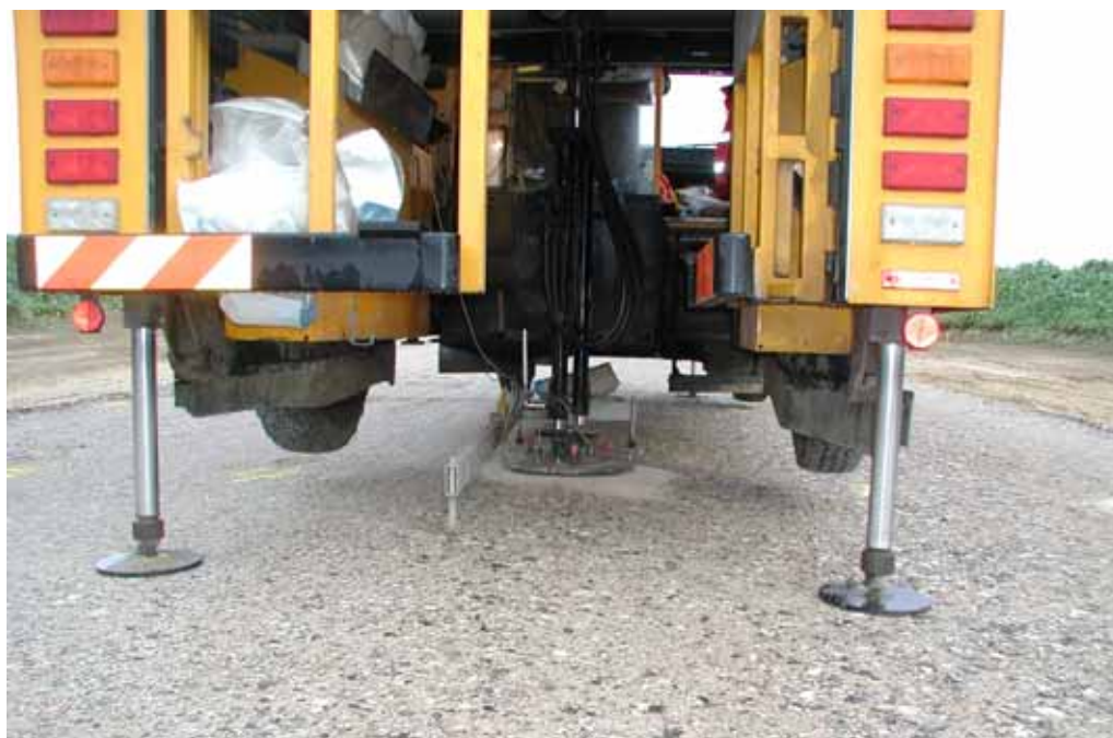
Figur 2. Detalje af pladebelastningsbus under måling. I midten ses belastningspladen på overfladen af et grusbærelag af stabilt grus. Det ses, at der anvendes afretningssand.
