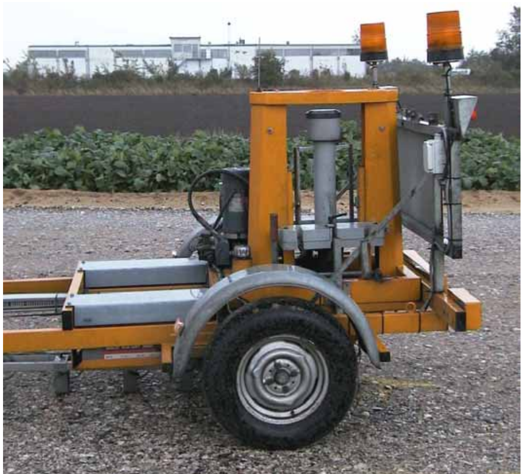
Figur 4. Faldloddet set fra siden med vægtsystem (i sænket position) over belastningspladen. Foran hjulet ses geofonerne, som registrerer vejoverfladens nedsynkning som følge af faldloddets belastning.
