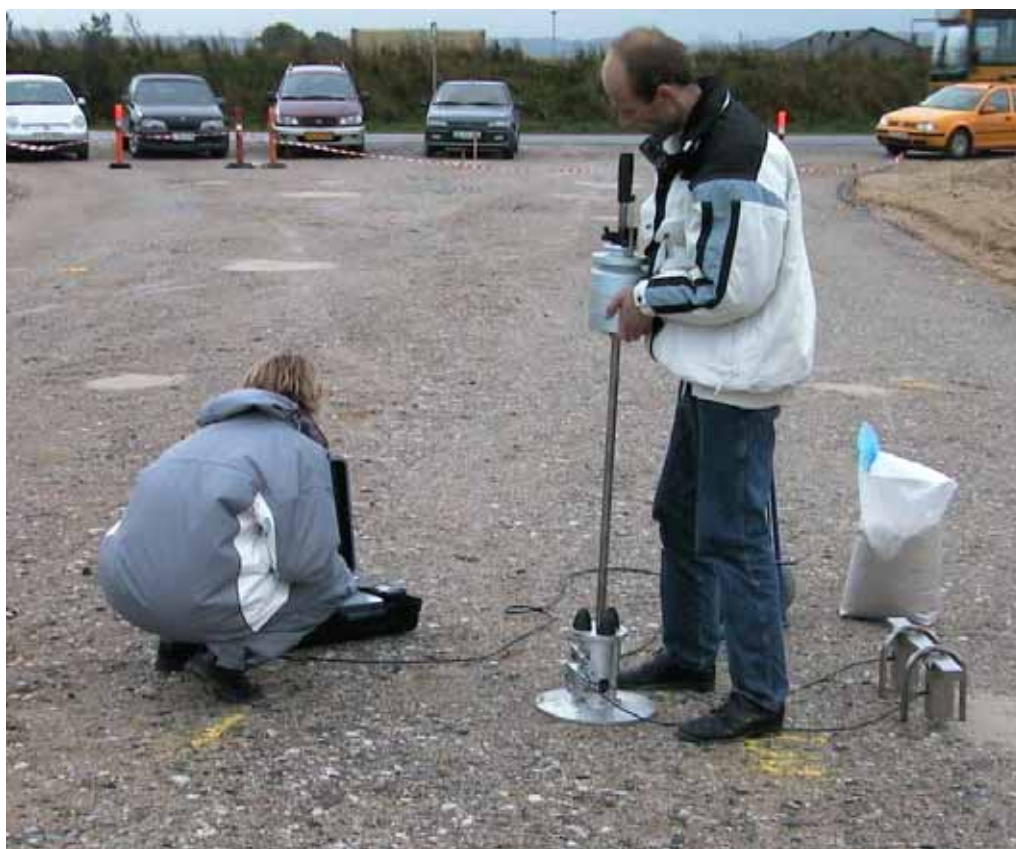
Figur 7. Keros Prima 100-minifaldlodet ved forberedelse til måling. Nederst til højre ses udstyret med to ekstra geofoner.
