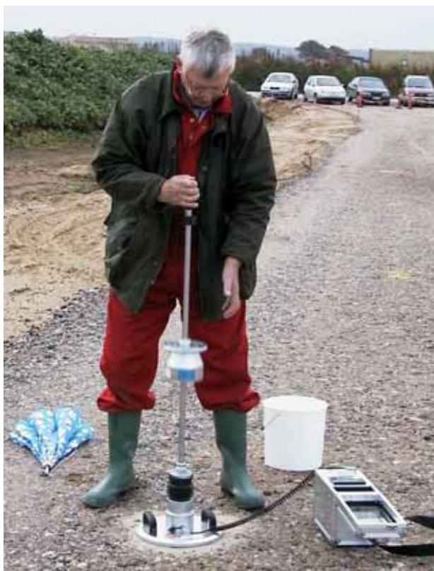
Figur 9. Zorn-minifaldloddet i brug. Til højre ses dataopsamlingsenhed.
