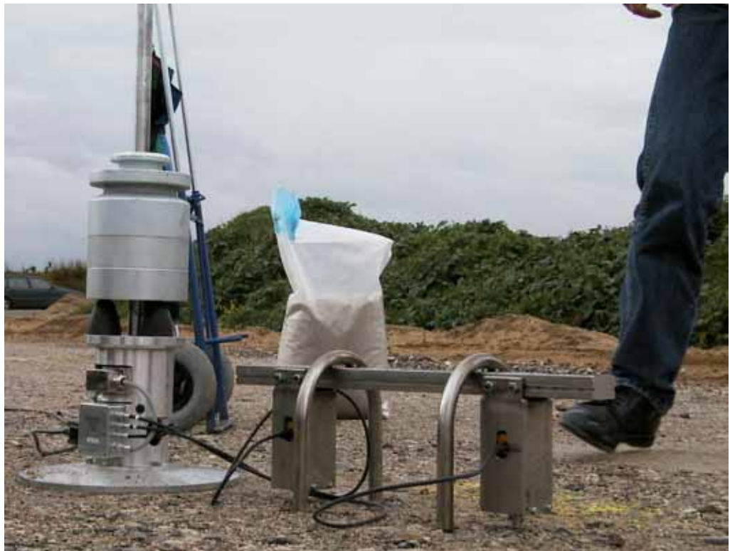
Figur 8. Detalje af Keros Prima 100-minifaldlod. Vægtklodsen står ovenpå buffersystemet og de to ekstra geofoner ses midt i billedet.
