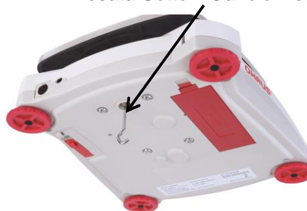
Pesata Sotto il Gancio installato
